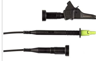
Das Kabelset KS 24 besteht aus einem 4 m langen Verlängerungskabel mit fest angeschlossener Prüfspitze an einem Ende und einer berührungs geschützten Buchse am anderen Ende sowie einen auf die Prüfspitze aufsteckbaren Krokodilclip.
